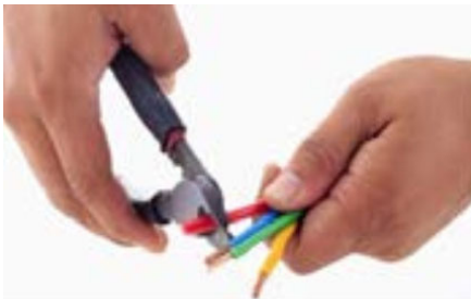
காவலியகற்றி (wire stripper) யைப் பயன்படுத்தி காவலியை அகற்றுதல்
